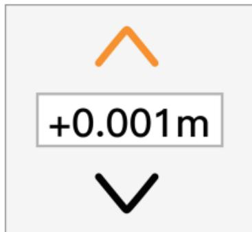
自助校准功能主要用于修正数据，当用户测量距离发生偏差时，可用该功能修正距离，修正范围：-0.009~0.009m。比如用户认为偏大2mm，可将此值调整值-0.002m，即可补偿2mm；反之偏小2mm，则调整至0.002m。操作如下：
