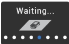
请将仪器静止放置，等待约3s时间即可完成校准，(若期间有震动，将导致仪器无法校准完成)，用户可短按
