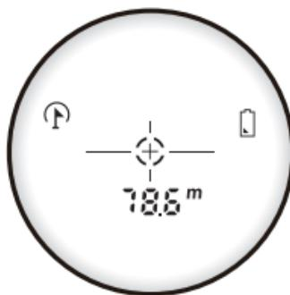
旗杆锁定功能，用于帮助测量信号塔，电线杆等细长目标。
