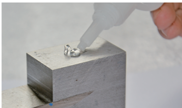
图2、将耦合剂涂抹均匀，将探头与被测材料表面紧密耦合。
